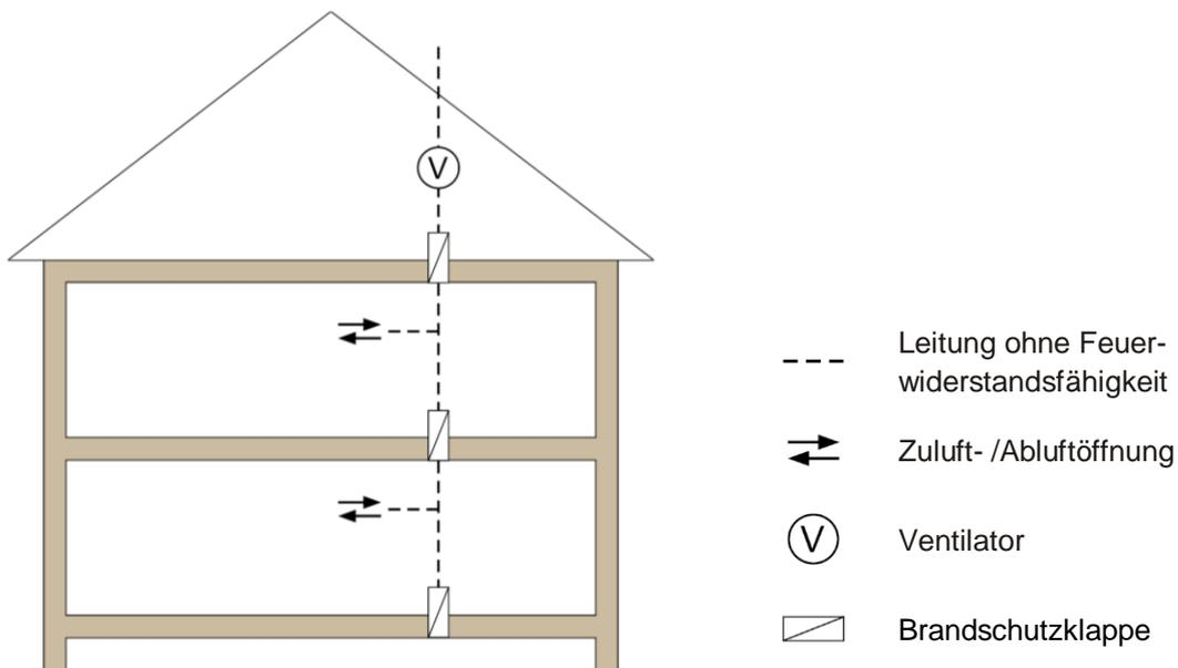
**Bild 2.2: Schachtlösung**
