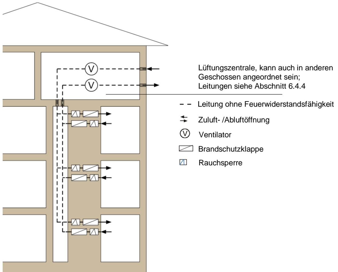
**Bild 6.2:** Beispiel für Schottlösung für Lüftungsanlagen nach DIN 18017-3:2009-09 maximaler Anschlussquerschnitt der Absperrvorrichtungen: 350 cm<sup>2</sup>
