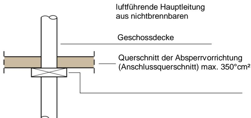
**6.3: Schachtlösung für Lüftungsanlagen nach DIN 18017-3:2009-09**
