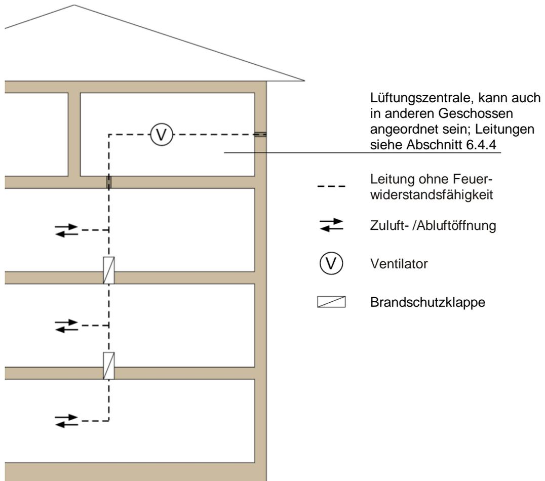
**Bild 1.2: Schachtlösung**
