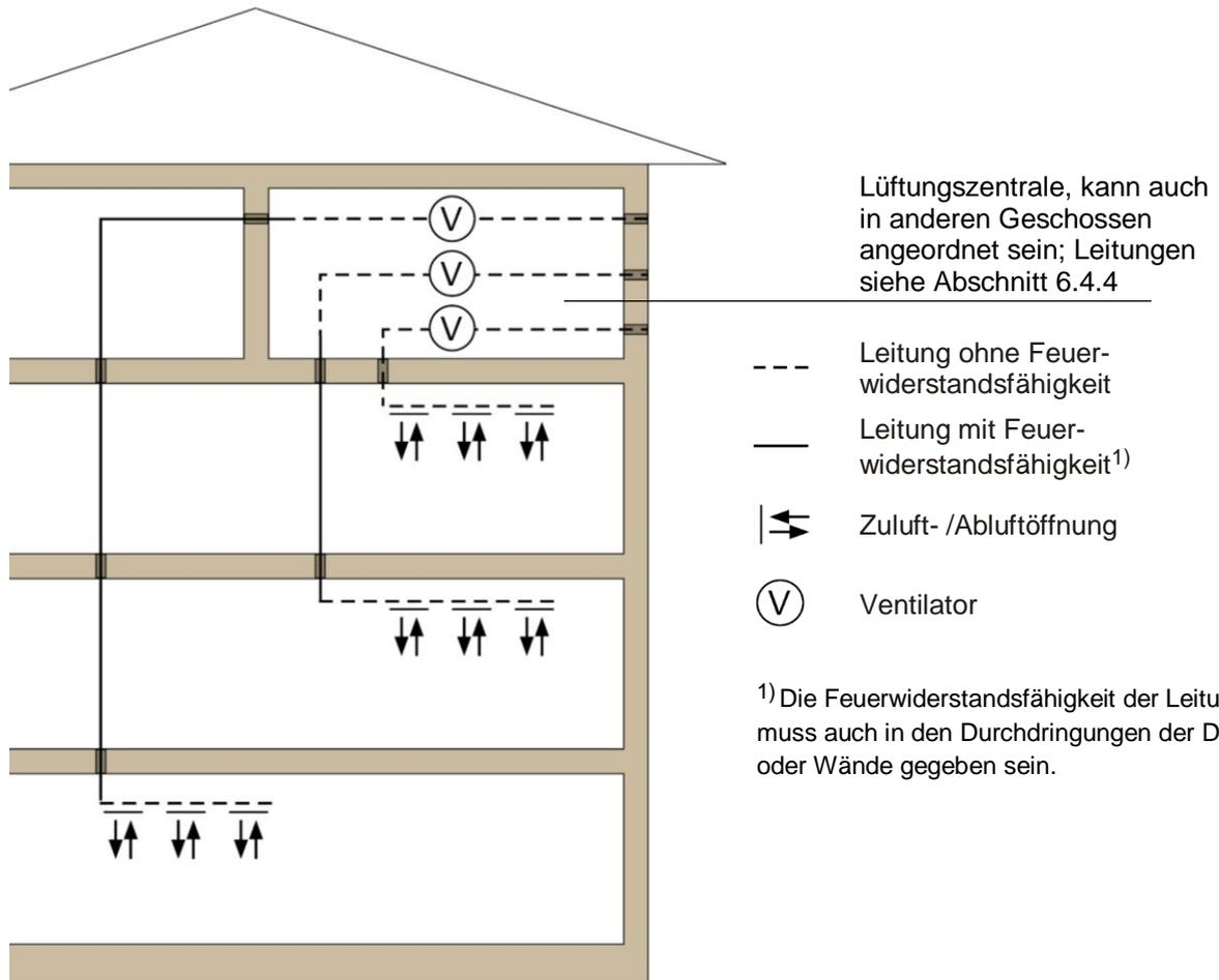
**Bild 1.4: Lüftungsanlagen mit getrennten Hauptleitungen und gemeinsamer Außenluft- oder Fortluftleitung mit Rauchschutz**
