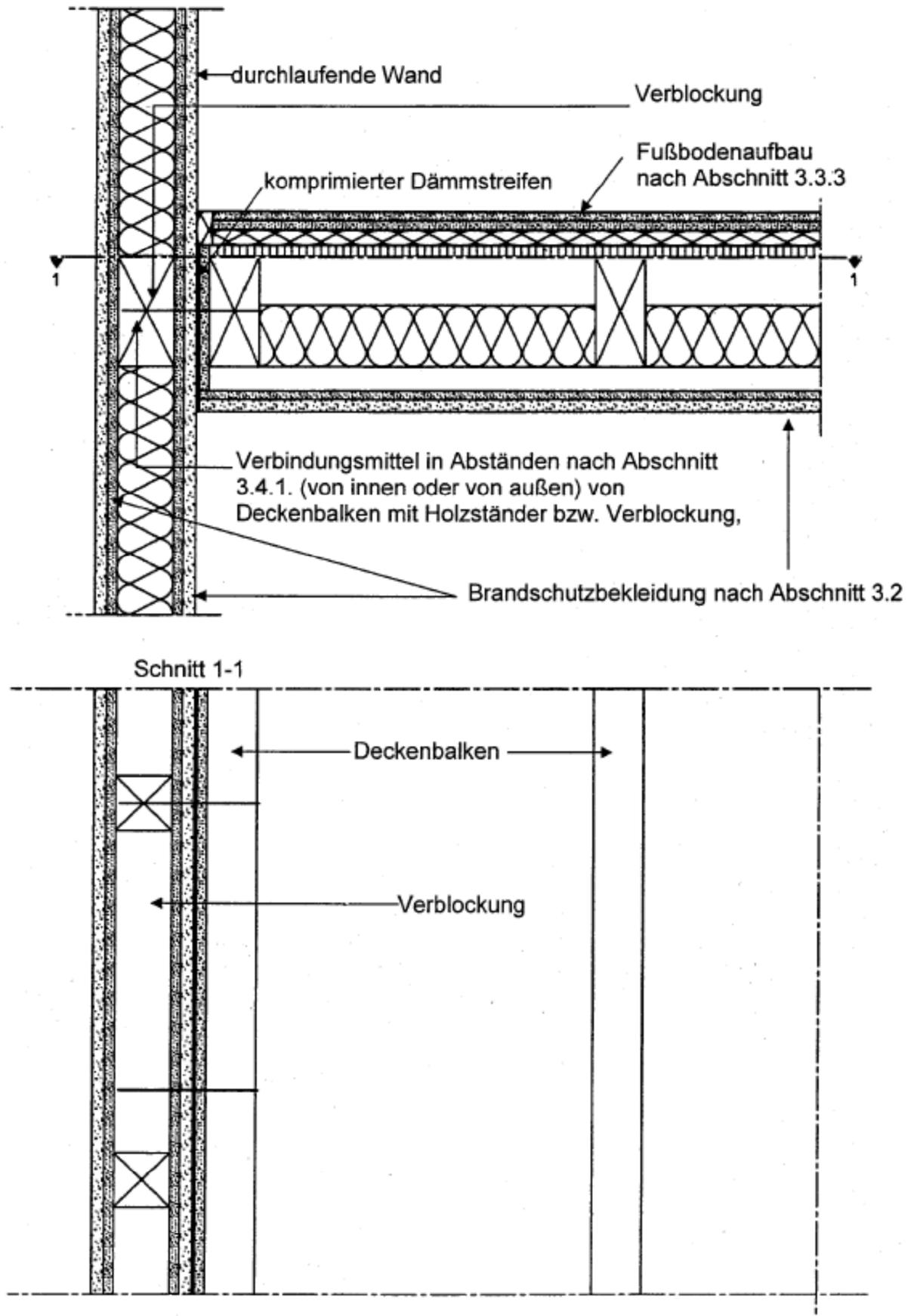
**Bild 2** Anschluss Decke nach Abschn. 3.3.3 an durchlaufende raumabschließende Wand nach Abschn. 3.3.2 (Treppenraumwand, Außenwand, auch nichttragend – Spannrichtung der Deckenbalken parallel zur Wand)
