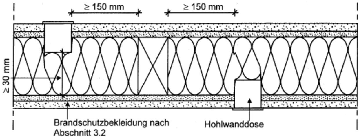
**Bild 9** Einbau einzelner Hohlwanddosen nach Abschnitt 4.2, Satz 1
