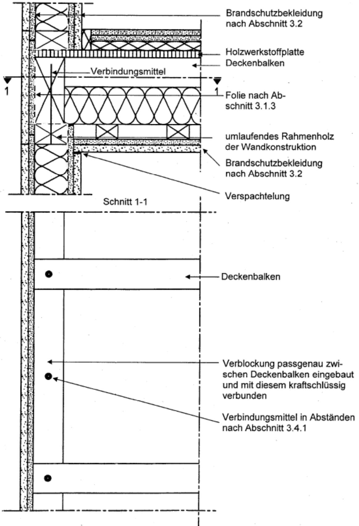
**Bild 1** Anschluss Decke nach Abschn. 3.3.3 an tragende und raumabschließende Wand nach Abschn. 3.3.2 mit Brandschutzbekleidung nach Abschn. 3.2 (z. B. Treppenraumwand, Außenwand – Spannrichtung der Deckenbalken senkrecht zur Wand)
