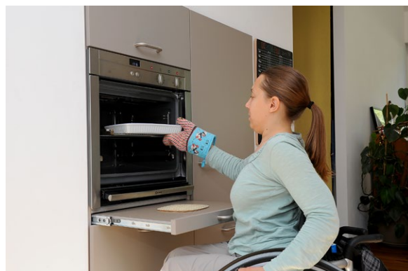
69–70 In einer mit dem Rollstuhl nutzbaren Küche ermöglicht eine unterfahrbare Spüle die frontale Nutzung. Ein Backofen mit versenkbarer Tür und Ablage bietet Schutz vor Verbrennungen; Privathaus, Mainz
